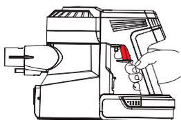
Premere l'interruttore per avviare l'apparecchio. Premere il pulsante di bloccaggio dell'interruttore per bloccare l'apparecchio in modalità di funzionamento continuo.
