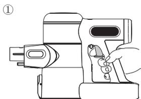
L'impostazione predefinita all'avvio è AUTO. L'apparecchio impiega quindi 3 secondi per rilevare inizialmente blocchi o polvere. Se non viene rilevata polvere, la potenza verrà ridotta per risparmiare energia.
