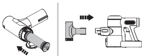
Inserire un filtro pulito nell'unità principale. Inserire il prefiltro sporco nell'utensile di pulizia e collegare l'utensile di pulizia all'unità principale.
