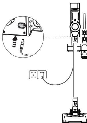
Posizionare l'unità principale sul supporto e collegare l'adattatore e la porta di ricarica. L'indicatore dell'unità principale che lampeggia in blu indica che si sta ricaricando correttamente.
