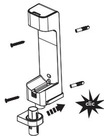
Montare i due componenti della staffa; un "clic" ne indicherà il corretto assemblaggio. Una volta completato questo passaggio, utilizzare le viti fornite da Tineco per fissare il supporto alla parete.
