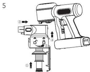
Dopo la pulizia, inserire il prefiltro pulito nel filtro a rete correttamente e scatta in posizione. Installare i filtri puliti e il contenitore della polvere all'interno dell'unità principale, quindi chiudere lo sportello del contenitore della polvere.
