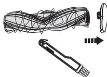
Rimuovere i detriti avvolti attorno al rullo con lo strumento di pulizia per capelli/peli Tineco.
