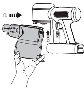
Quando si ricollega il contenitore della polvere, tenere un angolo e incastrare la parte superiore del contenitore della polvere nel gancio sul corpo principale. Spingere verso l'alto finché il gancio è fisso nella fessura sul contenitore stesso e scatta in posizione.
