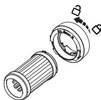
\* Il filtro HEPA è rimovibile. Basta ruotarlo per rimuoverlo e sostituirlo.
