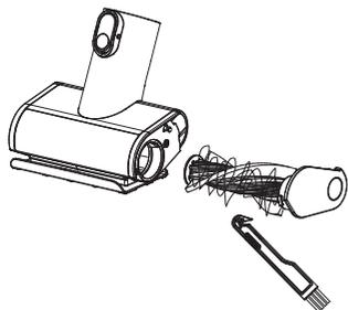
Rimuovere i detriti avvolti attorno al rullo con lo strumento di pulizia per capelli/peli Tineco.
