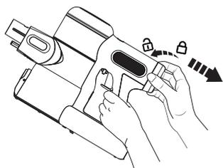
Ruotare il filtro HEPA a sinistra ed estrarlo delicatamente per pulirlo. Non utilizzare l'apparecchio senza aver prima installato il filtro HEPA.
