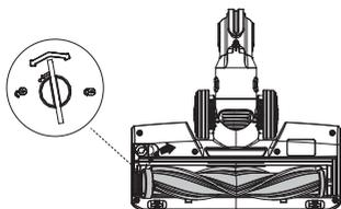
Usando una moneta o un altro strumento, ruotare il dispositivo di blocco del rullo della spazzola, quindi estrarlo.
