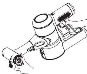
Attivare l'apparecchio in modalità MAX e ruotare il coperchio laterale per pulire il prefiltro dallo sporco.
