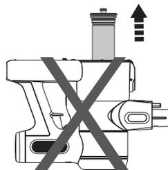
Non capovolgere l'apparecchio quando si rimuove o si installa il filtro per impedire alla polvere di penetrare nel motore.
