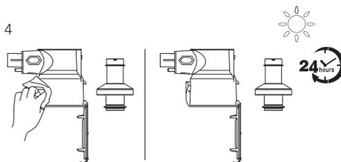
Pulire il contenitore della polvere e il filtro in rete con un panno umido. Prima di riassemble l'apparecchio, asciugare completamente all'aria.
