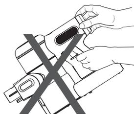
Non posizionare l'apparecchio come indicato sopra durante la rimozione o l'installazione del filtro HEPA, per evitare che la polvere penetri nel motore.
